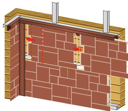
**3.1** Панель насадите опорными штырями в стартовую планку и выравнивайте по углу. Панель надежно зафиксируйте на стартовой планке, но при этом она должна иметь свободу передвижения при изменении температуры.
