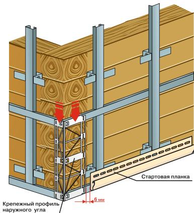
Строго горизонтально установите на стену стартовые планки и строго вертикально — крепежные профили наружного угла. Оставьте между ними зазор на температурное расширение 6 мм.
