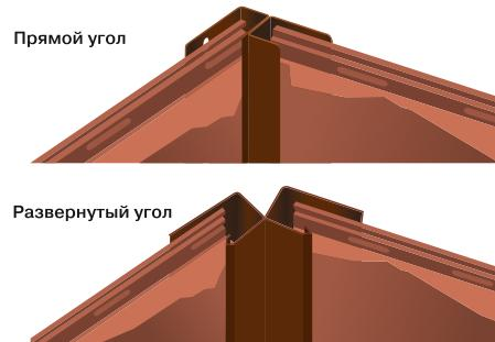
Используйте два J-профиля для обрамления внутреннего угла. Установите саморез в верхней части гвоздевого отверстия. Остальные саморезы устанавливайте по центру гвоздевых отверстий. Шаг монтажа выдерживайте 150-200 мм. Вставьте фасадную панель в J-профиль.
