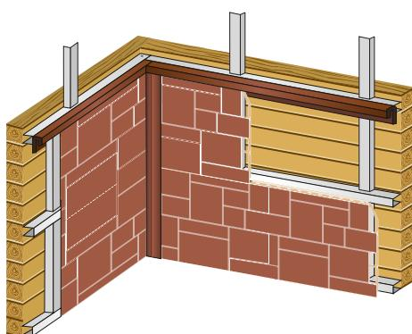
Для завершения монтажа панели закрепите J-профиль в верхней точке. Введите панель в J-профиль.
